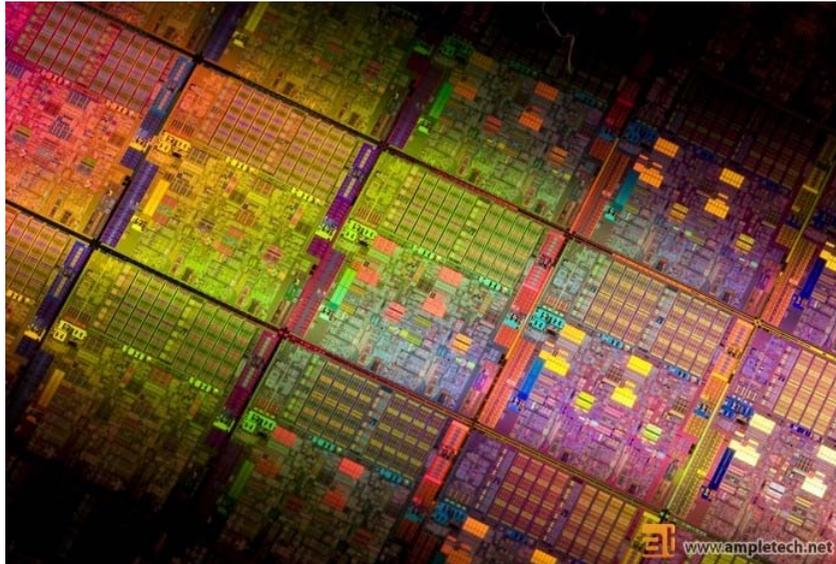
**2010 - Westmere (Clarkdale)** 2 cores i7 processor, 2.66 GHz. **2 miliardi di transistor**; Lunghezza di 1 transistor=32 nm - Chip Size: 3 cm<sup>2</sup>; Spessore del film dielettrico: 0,9 nm (2 strati atomici)
